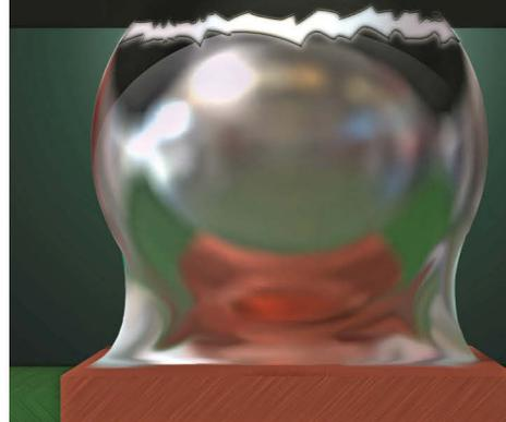
**FAILED SOLDER JOINT**
